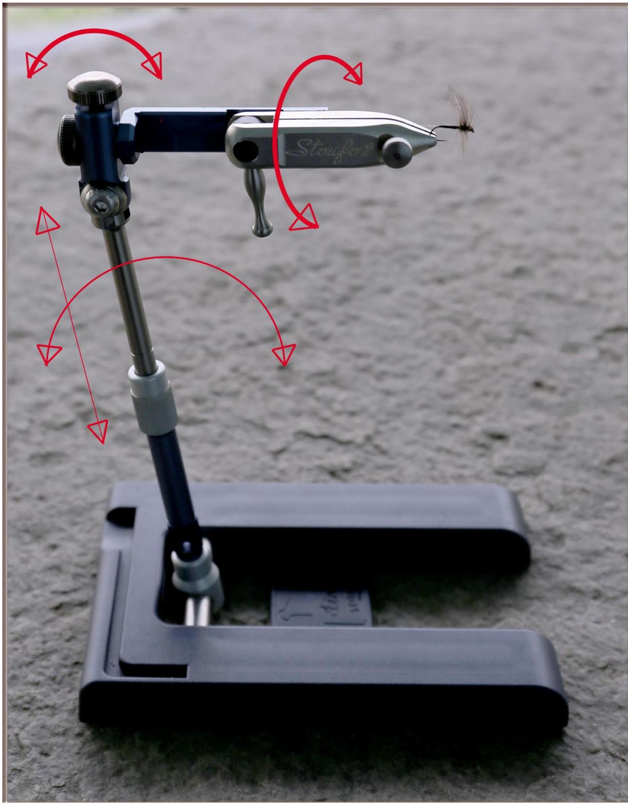
Il morsetto è facilmente e velocemente montabile attraverso una serie di snodi e di bloccaggi eseguibili in parte tramite ghiera zigrinate, ed in parte tramite una piccola chiave a brugola presente nella confezione.
