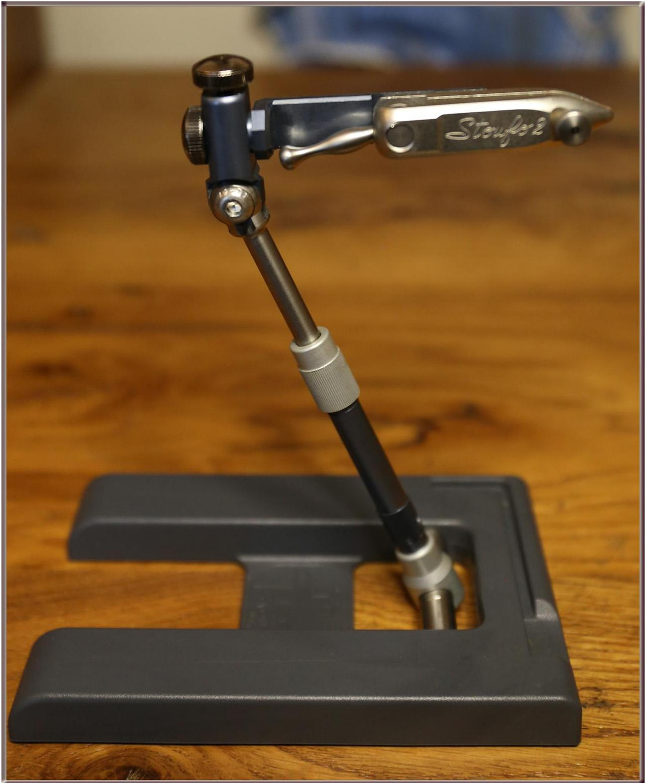
Con riferimento al serraggio del filo sull'amo ho riscontrato quello che a mio avviso, è il difetto principale di questo morsetto, ovvero la non eccessiva tenuta del bloccaggio inferiore dell'asta sull'albero. Questo fatto implica (per un costruttore destro) che, quando si avvolge o si stringe con operazioni che richiedono una certa forza, si tende naturalmente ad applicare un momento di rotazione destrorso sulla testa del morsetto che si ripercuote sull'asta con il rischio di sbloccarla.
